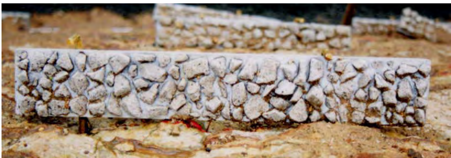
セメントボードに吸水性ミラクルソルを埋設した「ミラクルボード」
