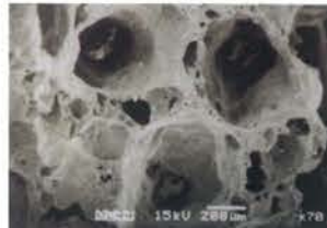
写真3-1 クリスタルバイオ(浮上タイプCB)の顕微鏡写真 撮影：佐賀大学 (FE-SEM)×70
