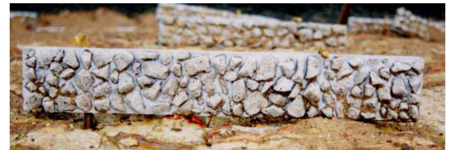
セメントボードに吸水性ミラクルソルを埋設した「ミラクルボード」
