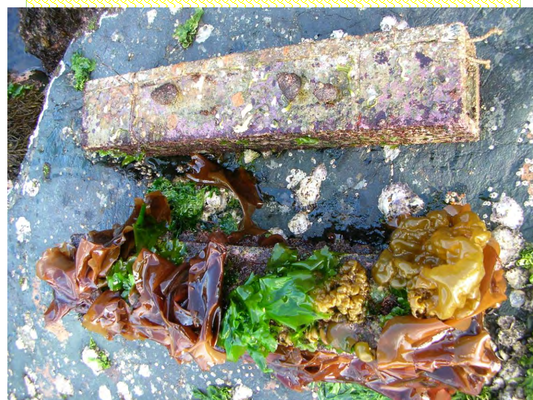
設置2年7ヵ月後(2005年3月)海藻類の繁茂状況
